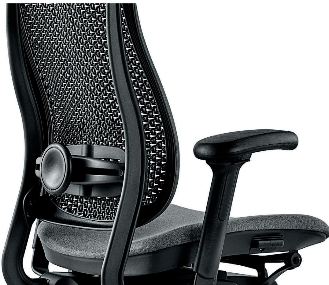
Jerome Caruso, le concepteur du siège Celle, a imaginé une surface composée de centaines de minuscules « cellules », chacune composée d'un coussinet doté de ressorts en forme de boucles destinés à soutenir et à réagir à différentes zones du corps.
