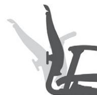
Lorsque que vous vous penchez en avant, le mécanisme de bascule Harmonic™ du siège Celle permet au dossier d'épouser le bas de votre dos, pour assurer votre maintien pendant que vous bougez, naturellement, à travers le large intervalle d'inclinaison de 28 degrés du siège.
